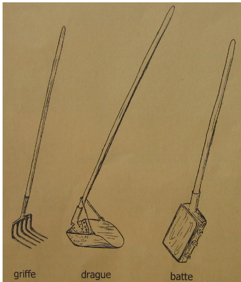
Outils d'entretien des fossés et des berges
